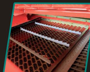
Sistema de limpia que permite trillar con menos desperdicios debido a su largo cilindro de φ620 mm x 1954 mm, aunado a una amplia área perforada.
